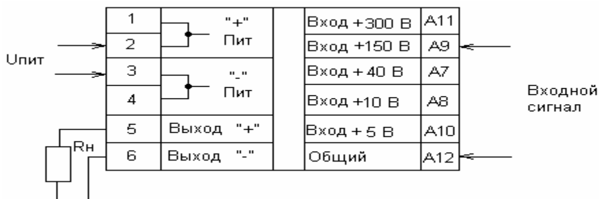
Рисунок 1.5 - Схема подключения к ПИ при измерении входного сигнала от 0 до 150 В
