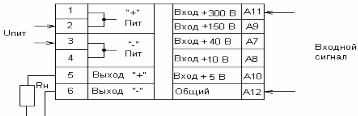
Рисунок 1.6 - Схема подключения к ПИ при измерении входного сигнала от 0 до 300 В
