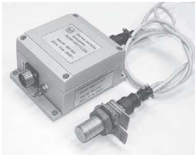
Датчик частоты вращения ИЦФР.408113.030: 1 – индуктор ИКЛЖ.408113.001; 2 – УФ ИЦФР.468171.001; 3 – жгут питания ИЦФР.685621.067; 4 – жгут ИЦФР.685621.068
