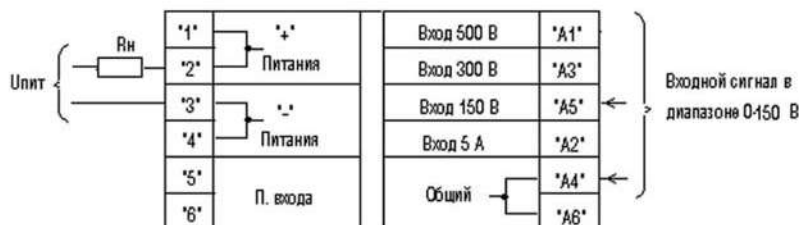
Рис. 1.3. Пример подключения для диапазонов U_{вх} 0–150 В
