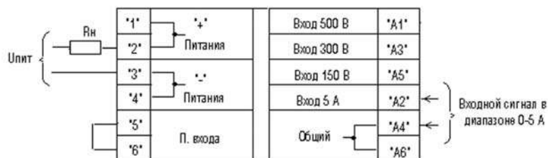
Рис. 1.4. Пример подключения для диапазона I_{вх} 0–5 А
