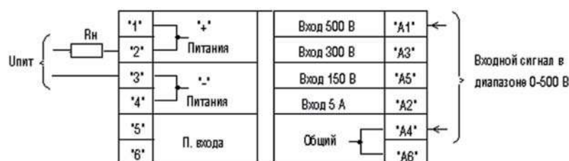
Рис. 1.1. Пример подключения для диапазона U_{\text{вх}} 0–500 В
