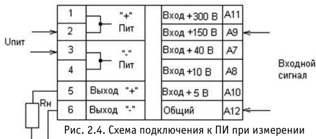
Рис. 2.3. Схема подключения к ПИ при измерении входного сигнала от 0 до 40 В
